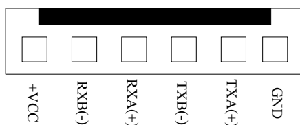
แสดงหัวต่อสัญญาณ RS422/485 ของบอร์ด CP-PIC V4.0 เมื่อเลือกเป็น RS422
