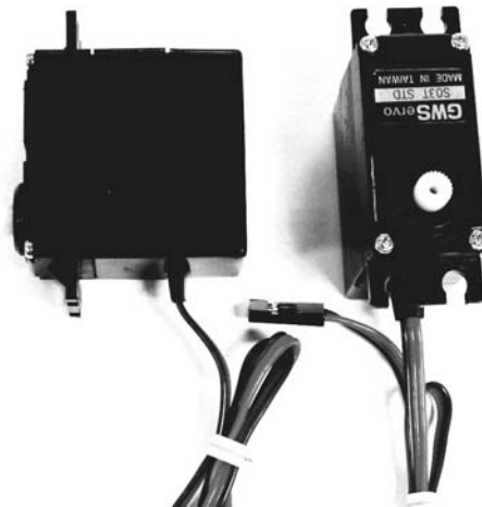
รูปที่ 1.13 ลักษณะของภายนอก Servo Motor
