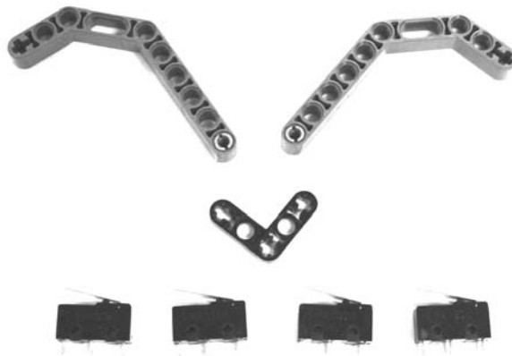
รูปที่ 1.12 แสดงลักษณะสวิตช์กันชนต่างๆ ของหุ่นยนต์
