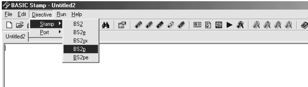
รูปที่ 3.9 แสดงการเลือกเบอร์ของตัว Basic Stamp ที่ใช้
