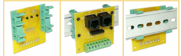
รูปต่อกับรางระบบ DIN 35 mm.
