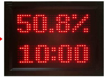
(8) บน-แสดง วันของสัปดาห์ (ตัวย่อ) กับวันที่, อุณหภูมิ, %ความชื้น โดยจะแสดงวนสลับกันครั้งละ 10 วินาที ล่าง-แสดงเวลา ชั่วโมง:นาที
