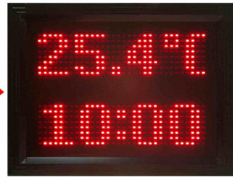
(8) บน-แสดง วันของสัปดาห์ (ตัวย่อ) กับวันที่, อุณหภูมิ, %ความชื้น โดยจะแสดงวนสลับกันครั้งละ 10 วินาที ล่าง-แสดงเวลา ชั่วโมง:นาที
