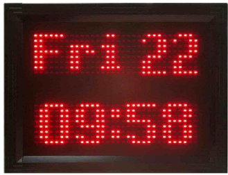
(8) บน-แสดง วันของสัปดาห์ (ตัวย่อ) กับวันที่, อุณหภูมิ, %ความชื้น โดยจะแสดงวนสลับกันครั้งละ 10 วินาที ล่าง-แสดงเวลา ชั่วโมง:นาที
