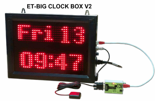
● รูปตัวอย่างการต่อใช้งาน ET-BIG CLOCK BOX V2 เข้ากับชุด ET-GPS-RS485
