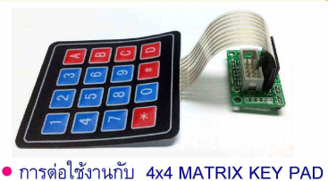
• การต่อใช้งานกับ 4x4 MATRIX KEY PAD
