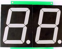
**ชุด DISPLAY**...ตัวเลข แบบ 7-SEGMENT ขนาดใหญ่ 2 หลัก เป็นลักษณะ LED แบบ 7-SEGMENT ขนาดสูง 4 นิ้ว สีแดง มองเห็นได้ในระยะไกล ใช้ต่อ กับระบบไมโครดิจิตอล ด้วยสัญญาณควบคุมซึ่งเพียง 3 เส้น โดยสามารถต่อพ่วง ET-BIG 7 X2 เข้าด้วยกันได้หลายๆ หน่วย ...
