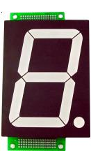
**ET-BIG 7x1** ... ชุด DISPLAY แบบ LED 7-SEGMENT สำหรับตัวเลขขนาดใหญ่ สูง 4 นิ้ว 1 หลัก ใช้สัญญาณเพียง 3 เส้น ในการต่อใช้งาน สามารถต่อพ่วงกับชุด ET-BIG 7x2 ได้ ...
