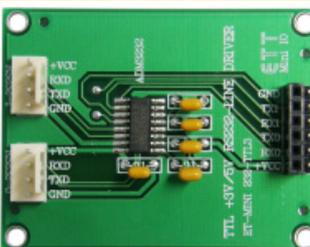
เป็นชุดใช้ต่อทดลอง หรือต่อ ใช้งานวงจร RS232 ที่สามารถต่อใช้งานได้ ขนาด VCC 3V ถึง 5VDC ต่อวงจร RS232 ได้ 2 ช่อง แบบ 4 PIN ETT ขั้วต่อ HEADER ตัวผู้ 6 PIN และตัวเมีย 6 PIN ใช้ IC DRIVER เบอร์ ADM3232 หรือเบอร์แทน พร้อมคู่มือการใช้งาน
