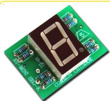
เป็นวงจร LED 7-SEGMENT สีแดง ขนาด 1 หลัก พร้อมวงจร R ต่อกับ 7-SEGMENT ขั้วต่อ INPUT เป็นแบบ 10PIN ตัวเมียสามารถต่อเข้ากับขั้วต่อ I/O แบบ 10 PIN ของ อีทีที ได้โดยตรง
