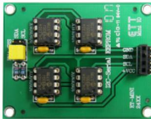
เป็นชุดต่อทดลองและใช้งานกับระบบ I<sup>2</sup>C BUS โดยใช้ IC EEPROM ขนาด 2KBYTE เบอร์ 24LC32 จำนวน 4 ตัว เพื่อให้สามารถเลือกใช้งานคนละตำแหน่งของ I<sup>2</sup>C ได้ ขั้วต่อ HEADER ตัวผู้ 4 PIN และตัวเมีย 4 PIN พร้อมคู่มือการใช้งาน
