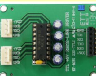
เป็นชุดใช้ต่อทดลองหรือต่อใช้งานวงจร RS232 ต่อเข้ากับ VCC 5VDC ต่อวงจร RS232 ได้ 2 ช่อง แบบ 4 PIN ETT ขั้วต่อ HEADER ตัวผู้ 6 PIN และตัวเมีย 6 PIN ใช้ IC DRIVER เบอร์ MAX232 พร้อมคู่มือการใช้งาน
