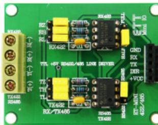
เป็นชุดใช้ต่อทดลองหรือต่อใช้งานวงจร RS422/485 ใช้ IC 75176 จำนวน 2 ตัว ต่อในแบบ RS422 หรือ RS485 พร้อม JUMPER เลือก SET ใช้งาน ขั้วต่อ HEADER ตัวผู้ 5 PIN และตัวเมีย 5 PIN พร้อมคู่มือ
