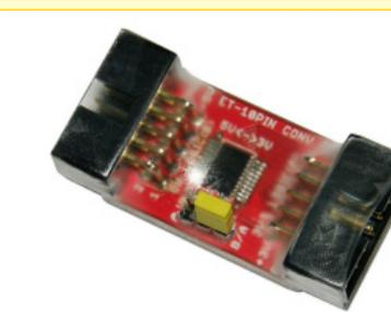
เป็นบอร์ดวงจรขนาดเล็ก พร้อม 2 ขั้วต่อ 10PIN ET BUS I/O ออกแบบให้สามารถต่อเข้ากับสายแพร 10PIN ได้โดยสะดวก ใช้ในการเชื่อมต่อวงจรสัญญาณลอจิกระหว่างอุปกรณ์ 5V เข้ากับอุปกรณ์สัญญาณ 3.3V โดยใช้ ไอซี 74LCX245 เป็นตัวกลางในการเชื่อมต่อ
