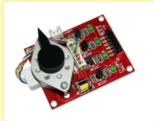
ปรับปรุงให้สามารถต่อใช้ไฟที่ขั้วขั้ว STEPPING MOTOR จากภายนอกได้พร้อมทั้งเพิ่มวงจรจ่ายไฟในการขับ STEPPING MOTOR ขึ้นมาโดยเฉพาะ ใช้ไอซีเบอร์ MC 34063 วงจรขับ STEPPING MOTOR แบบ 4 ขด โดยใช้ TR BC337 จำนวน 4 ตัว พร้อม LED แสดงสถานะการทำงาน, พร้อมเชื่อมต่อแสดงทิศทางหมุนขั้วต่อแบบ PIN HEADER 6 PIN
