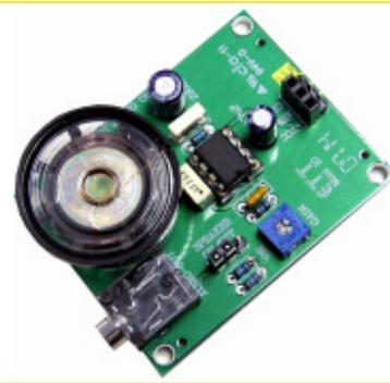
เป็นบอร์ดวงจรขยายเสียงขนาดเล็ก พร้อมลำโพงบนบอร์ด พร้อม STEREO JACK สำหรับเชื่อมต่อกับชุดลำโพงหูฟังหรือชุดเครื่องขยายเสียงภายนอก พร้อมคู่มือการใช้งาน
