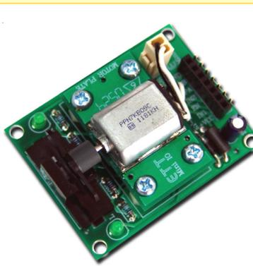
เป็นชุดต่อทดลองการใช้งานของวงจร DC MOTOR TOR พร้อมวงจรส่วน OPTO INPUT SENSOR แบบ 2 ช่อง สัญญาณ ใช้ในการทดสอบทิศทางการหมุนและทดสอบความเร็วของ DC MOTOR พร้อมชุดใบพัดตัดแสง, วงจรขับ DC MOTOR ใช้ IC เบอร์ L293D ในการทำงาน ขั้ว INPUT สัญญาณเข้าแบบ 7 PIN ตัวผู้และตัวเมีย พร้อมคู่มือการใช้งาน
