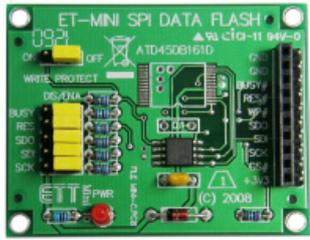
เป็นบอร์ดหน่วยความจำแบบ Flash Memory ขนาด 2MBYTE โดยใช้ ไอซีเบอร์ AT45DB16 ของบริษัท ATMEL สามารถนำไปใช้งานเก็บข้อมูลต่างๆ ทำ DATA LOGGER
