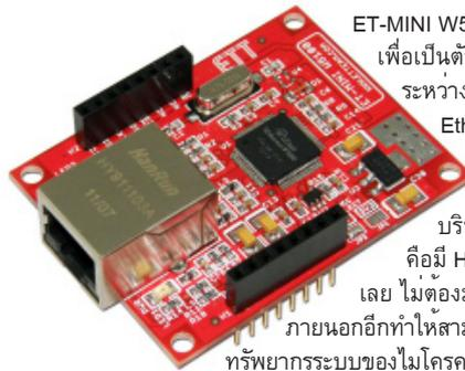
ET-MINI W5100 ... เป็นบอร์ดที่ออกแบบมาเพื่อเป็นตัวกลางในการเชื่อมต่อระบบสื่อสารระหว่างไมโครคอนโทรลเลอร์ที่ไม่มี PORT Ethernet กับโครงข่าย Ethernet โดยบอร์ดนี้จะใช้ชิพ Ethernet Controller เบอร์ W5100 ของบริษัท WIZnet ซึ่งข้อดีของชิพเบอร์นี้คือมี Hardwired TCP/IP stack ในตัวชิพเลย ไม่ต้องมาเขียน Software TCP/IP Stack ภายนอกอีกทำให้สามารถใช้งานได้ง่ายขึ้น และไม่เปลี่ยนทรัพยากรระบบของไมโครคอนโทรลเลอร์ ที่มาต่อรวมด้วย
