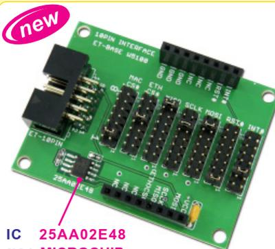
ET-BASE W5100 ... เป็นบอร์ดตัวกลางในการเชื่อมต่อระหว่างบอร์ด ET-MINI W5100 กับบอร์ดไมโครคอนโทรลเลอร์ต่างๆ ของ ไอทีที ที่ใช้ขั้วต่อมาตรฐาน 10 PIN ของ ไอทีที
