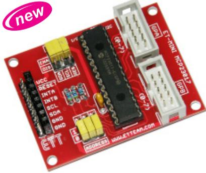
เป็นบอร์ดขยายจำนวน PORT I/O ให้กับ MCU ต่างๆ โดยมีขนาด 16 BIT I/O สามารถต่อกับ MCU ที่ใช้ไฟได้ตั้งแต่ 1.8V - 5.5V
