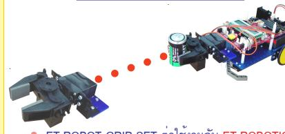
● ET-ROBOT GRIP SET ต่อใช้งานกับ ET-ROBOTICS
