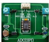
ชุดทดลอง A/D 8 BIT 2 CHANNELS
