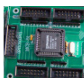
ET-LAB3A มี CPU MCS-51 เบอร์ P89V51RD2 หน่วยความจำ 64K BYTE แบบ FLASH
