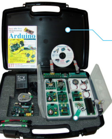
บอร์ดไมโครคอนโทรลเลอร์ในรุ่น ET-BASE AVR EASY328 TRAINING BOX, ET-BASE AVR EASY168 TRAINING BOX, ET-BASE AVR EASY88 TRAINING BOX ตัวบอร์ดเหมือนกันต่างกันใน MCU ในแต่ละรุ่น
