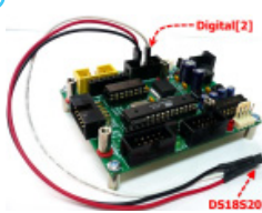
บอร์ดไมโครคอนโทรลเลอร์ในรุ่น ET-BASE AVR EASY328 TRAINING BOX, ET-BASE AVR EASY168 TRAINING BOX, ET-BASE AVR EASY88 TRAINING BOX ตัวบอร์ดเหมือนกันต่างกันใน MCU ในแต่ละรุ่น
