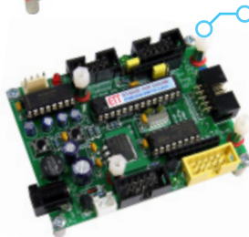
บอร์ดไมโครคอนโทรลเลอร์ในรุ่น ET-BASE AVR EASY328 TRAINING BOX, ET-BASE AVR EASY168 TRAINING BOX, ET-BASE AVR EASY88 TRAINING BOX ตัวบอร์ดเหมือนกันต่างกันใน MCU ในแต่ละรุ่น
